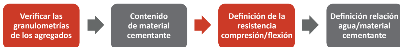
Ilustración 18 Proceso para el diseño de mezclas de concreto
