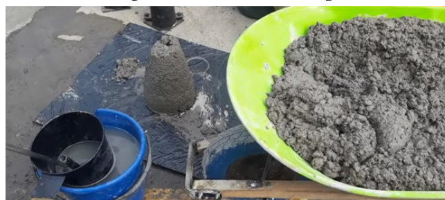
Figura 10 Prueba de slump.
