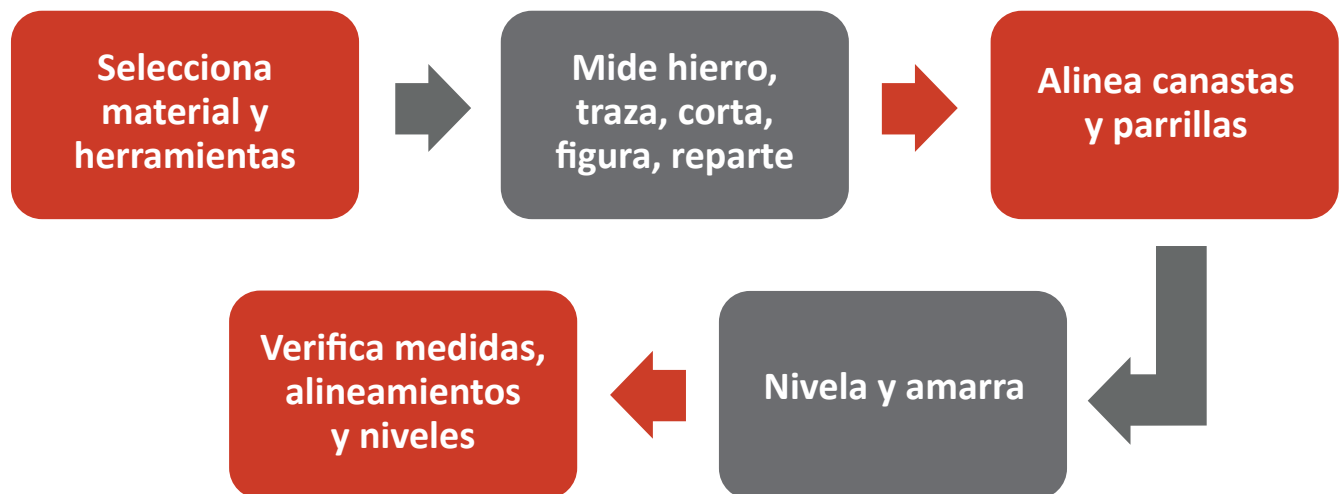
Ilustración 24 Proceso recomendado para armar estructura
