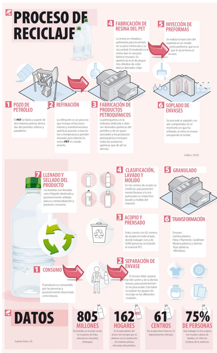
Figura 1. Proceso productivo para procesar y reciclar materiales de desecho derivados del plástico
