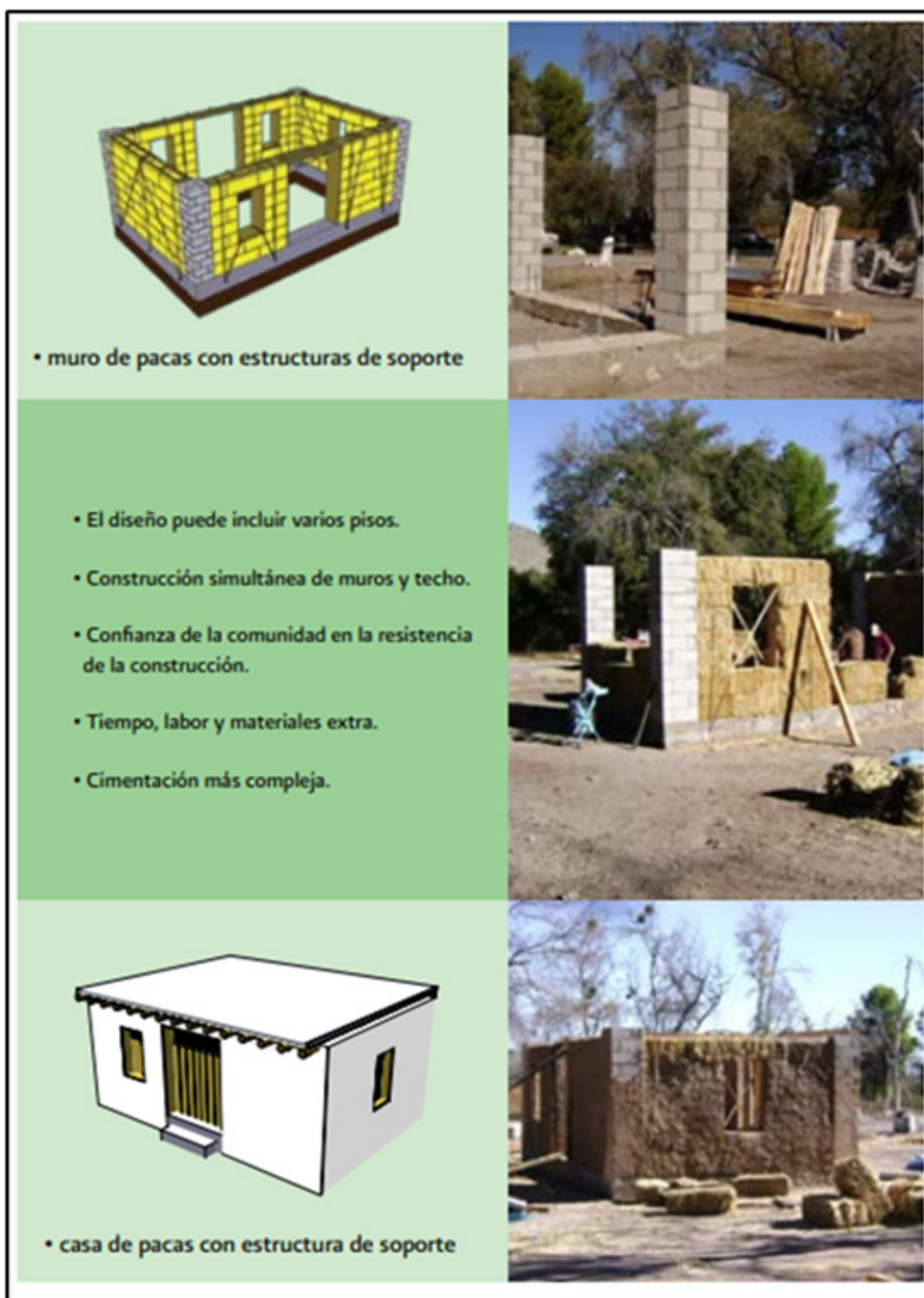
Figura 2. Muros de desechos agrícolas
