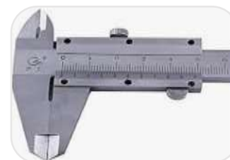
Calibrador: Se utiliza para medir pequeñas longitudes, profundidades y diámetros
